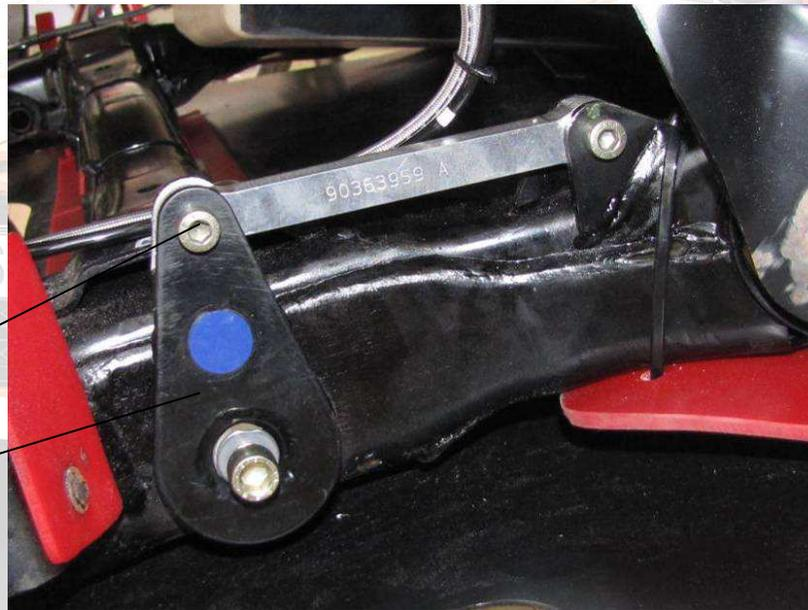
Appliquer de la graisse cuivre sur les canelures de la barre anti dévers puis insérer la barre anti dévers (rep. 2) dans la traverse arrière et la fixer au levier anti-dévers droit (rep. 1) à l'aide de la vis (rep. 11) et de la rondelle (rep. 12).
